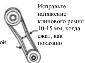
Рисунок 2. Натяжение клинового ремня
