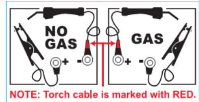
Первый способ используют при сварке обычной проволокой в газовой среде, а второй при работе с флюсовой проволокой без газа.
