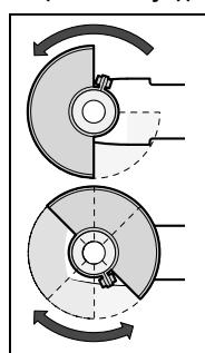
Наденьте защитный кожух 10 на шейку шпинделя. Настройте положение защитного кожуха 10 в зависимости от потребностей рабочей операции. Заденьте защитный кожух 10, затянув с помощью ключа-шестигранника 4 крепежный винт 9.
