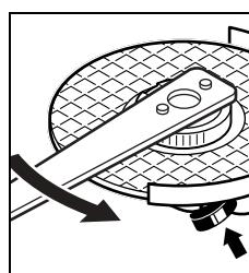
Правильно закрепленную, не имеющую повреждений быстрозажимную гайку Вы можете отвернуть, вращая рукой кольцо с наклейкой против часовой стрелки. **Никогда не отворачивайте** прочно сидящую быстрозажимную гайку **клещами**, а пользуйтесь **ключом для гаек с двумя торцевыми**
