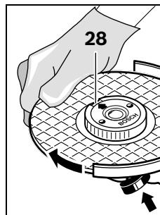
Для фиксирования шлифовального шпинделя нажмите кнопку фиксирования шпинделя **2**. Для затягивания быстрозажимной гайки поверните шлифовальный круг с усилием по часовой стрелке.
