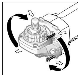
Вы можете повернуть редукторную головку шагами в 90°. Этим выключатель может быть поставлен в удобное для работы положение, например, для левши.
