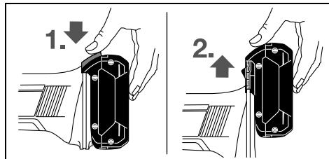
Для изъятия аккумулятора 5 нажмите кнопку разблокировки 6 и вытяните аккумулятор вперед из электроинструмента. **Не применяйте при этом силы.**
