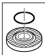
На опорном фланце **11** вокруг центрирующего буртика находится пластмассовая деталь (кольцо круглого сечения). **Если кольцо круглого сечения отсутствует или повреждено**, опорный фланец **11** необходимо обязательно заменить перед дальнейшим применением.
