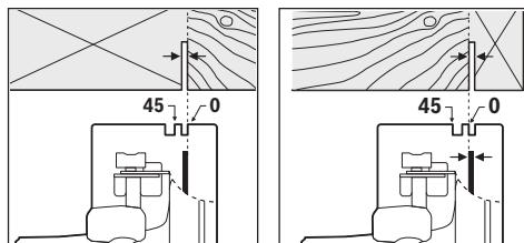
Метка линии распила  $0^\circ$  **(11)** показывает положение пильного диска при распиливании под прямым углом. Метка линии распила  $45^\circ$  **(10)** показывает положение пильного диска при распиливании под углом  $45^\circ$ . Для получения точного пропила установите дисковую пилу на заготовке согласно рисунку. Рекомендуется сделать пробный пропил.
