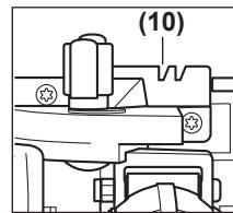
Используйте только метку угла пропила **(10)** при распиле под прямым углом и под углом  $45^\circ$  с направляющей шиной.
